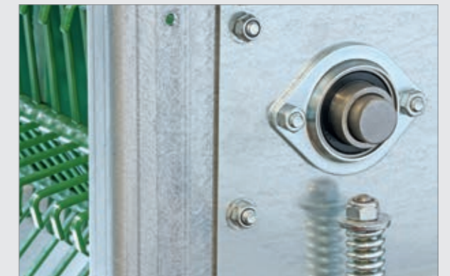
Flanschlager im Stahlblechgehäuse in einem Eierelevator
