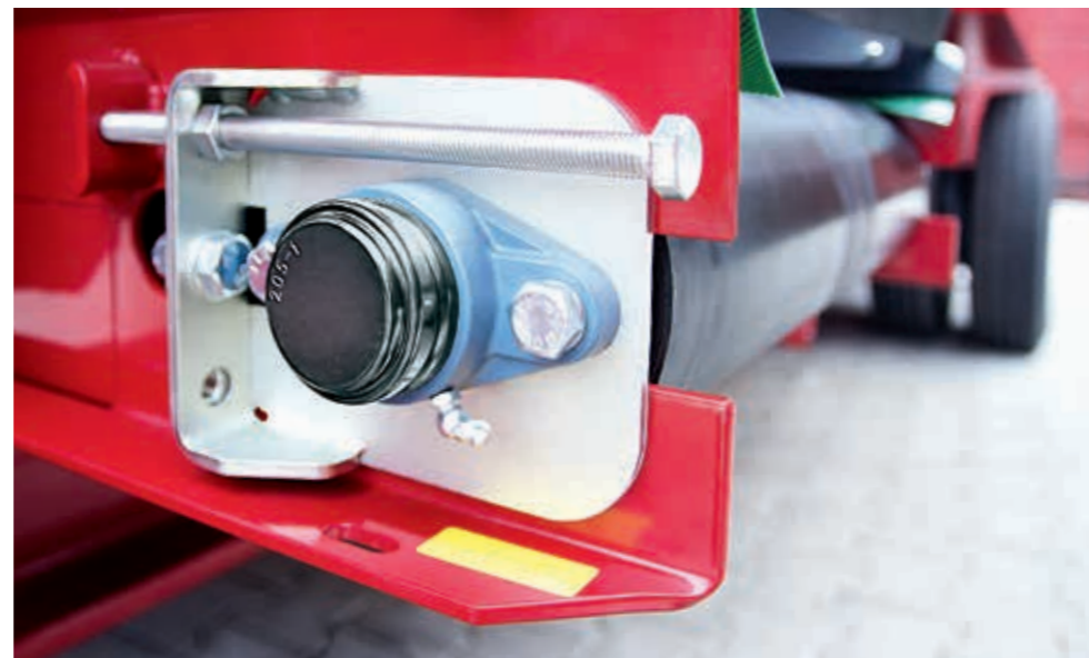
Spannstation für den Gummigurt des Förderbandes, mit Zweiloch-Flanschlagern und Schutzkappe
