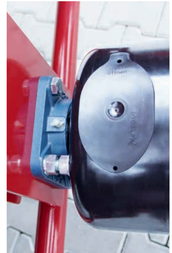
Durchtrieb der Gelenkwelle des Schleppers zum Mischergetriebe mit Schutzkopf für die Gelenkwelle
